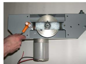
3 Avec la même clé Allen dévisser les 2 vis de l'étrier de renforce de l'arbre moteur.
