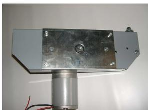
1 Dévisser les 4 vis du couvercle de protection avec une clé Allen de 6 mm.
