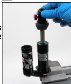
**Pour obtenir une valeur de couple précise, la clé dynamométrique doit être positionnée à un angle de 90° par rapport à la clé à ergots de 24 mm.**
