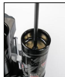
de l'amortisseur jusqu'à ce que plus aucune bulle ne sorte de l'orifice de purge du PFI puis, à l'aide d'une clé TORX® T10, installez tout de suite la vis de l'orifice de purge dans l'orifice de purge et serrez-la jusqu'à ce que le PFI commence à tourner.
