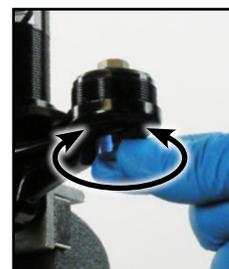
**L'unité de la valve de compression basse vitesse doit affleurer avec le haut du réservoir du PFI. Veillez à ne pas endommager le joint d'étanchéité principal lors de l'installation.**
