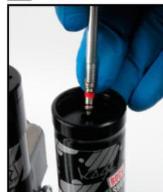
60. Mettez parfaitement en place l'anneau de blocage dans sa cannelure.
