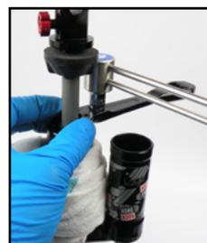
**Assurez-vous de réaliser cette étape lentement, en laissant le temps à l'air et au liquide de passer par les encoches.**
