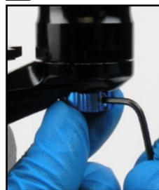
64. À l'aide d'une clé TORX T10, installez le capuchon de l'orifice de remplissage sur le bouchon du réservoir du PFI.
