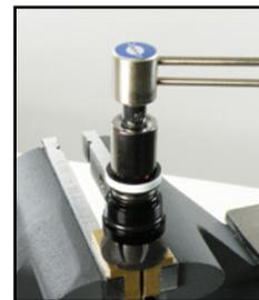
20. Retirez l'ensemble de la came de l'étau et laissez-le de côté jusqu'au chapitre intitulé **Purge de l'amortisseur et remontage.**
