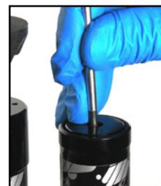
7. À l'aide d'une clé TORX T10, retirez le capuchon de l'orifice de remplissage sur le bouchon du réservoir du PFI puis videz la pression pneumatique en appuyant sur la valve. À l'aide de l'outil pour valve Schrader, retirez l'obus de la valve Schrader.
