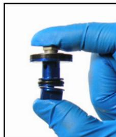
42. Insérez délicatement l'unité de la valve de compression basse vitesse dans le corps de l'amortisseur, la molette interne en premier. **Avec le doigt, guidez l'unité de la valve de compression basse vitesse pour la mettre bien en place.**
