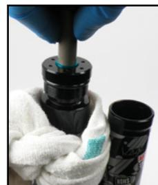
53. Maintenez l'unité de la came par la tête d'étanchéité et vissez **lentement** à la main la tête d'étanchéité sur l'amortisseur. L'air et le liquide emprisonnés devraient s'échapper par les encoches du filetage de la tête d'étanchéité. **N'appuyez pas sur la came ou sur l'œillet de la came. Cela déplacerait plus de liquide qu'il n'en faut pour le moment.**
