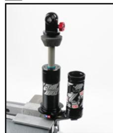
57. Retirez l'amortisseur de l'étau et videz l'excès de liquide se trouvant au-dessus du PFI. À l'aide d'un chiffon propre, essuyez les éventuelles coulures de liquide à l'intérieur du réservoir.
