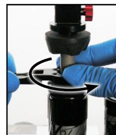
8. À l'aide d'une clé à ergots SRAM de 24 mm, desserrez et dévissez la tête d'étanchéité de l'amortisseur.
