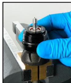
19. Remettez l'unité du piston en place sur l'unité de la came. Assurez-vous que le ressort de précontrainte est bien centré sur l'unité du piston. À l'aide d'une clé dynamométrique équipée d'une douille de 17 mm, serrez l'écrou du piston à un couple de 6,7 N·m. **Ne serrez pas trop !**
