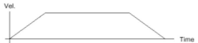
Figure 1.9 Profil trapézoïdal [6]
