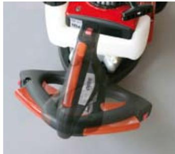
Dans l'univers des taille-haies, les Solo 160 et 161 sont équipés d'une poignée arrière rotative sur 7 positions. Dans chacune des positions, elle est inclinée d'environ 15° par rapport à l'axe de coupe. La main de l'utilisateur n'est donc pas en contact avec la haie.
