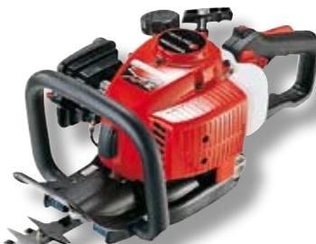
La gamme de tailleuses Zenoah comprend des modèles motorisés en Strato-Charged ou en 2 temps classiques avec système antivibration sur 4 points et boîtier professionnel en aluminium, biellettes avec roulements à rouleaux et lames plus épaisses. L'offre comprend aussi des modèles sur perche avec réglage de l'inclinaison de l'outil de coupe.
