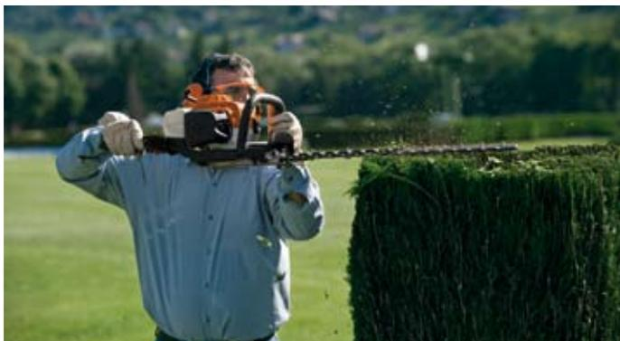
Dans le domaine des taille-haies, Stihl a optimisé l'équilibre et le report des masses. L'utilisateur porte plus facilement la machine et le poids est mieux réparti. L'évacuation des gaz d'échappement a aussi été repensée : les flux sont envoyés vers l'avant et non pas vers l'utilisateur.
