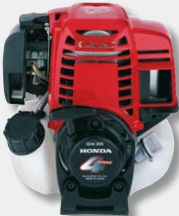
**Le Honda GX 35 de 35,8 cm<sup>3</sup> développe sa puissance maximale de 1,2 kW à 7000 tr/min. Son couple maximal de 1,9 Nm est atteint à 5500 tr/min.**
