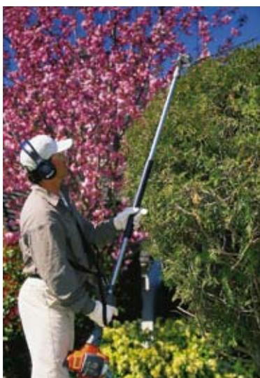
Les matériels de taille Husqvarna 325 HE4x et 325 HE3x, motorisés en E-Tech de  $24,5 \text{ cm}^3$ , reçoivent une lame de  $55 \text{ cm}$  pivotante sur  $180^\circ$ . Elle est rabattable pour le transport sur le 325 HE4x. Le modèle HE4x permet de tailler jusqu'à une hauteur de  $4 \text{ m}$ , le HE3x atteint les  $3 \text{ mètres}$ .
