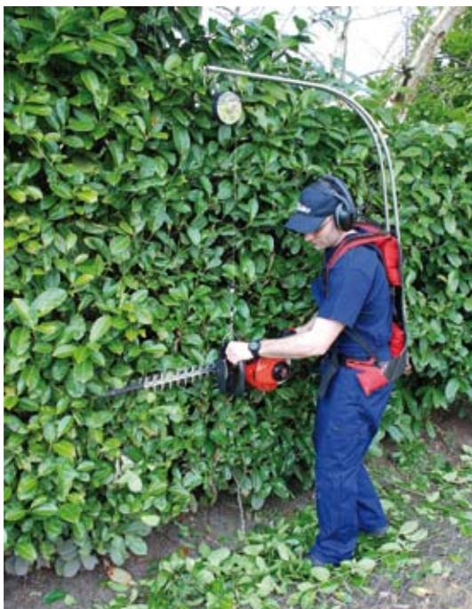
Le harnais Trompe d'éléphant de Green Technology est diffusé par la société Court. Le système comprend un enrouleur à ressort incorporé dont le câble se fixe sur la poignée du taille-haie. Le fournisseur précise que le réglage réduit le poids porté d'un taille-haies de 5,5 kg à 1,5 kg. Le câble s'enroule et se déroule et permet l'utilisation de la machine à différentes hauteurs.
