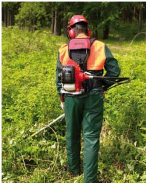
La gamme Shindaiwa (Béal) comprend la débroussailleuse BP 530 à moteur porté à dos. Elle est motorisée avec un deux-temps monocylindre refroidi par air de 53,2 cm<sup>3</sup>. La transmission du moteur au tube s'effectue avec un flexible gainé. La machine reçoit un système de démarrage assisté demandant trois fois moins d'efforts à l'utilisateur, elle peut être redémarrée sans déposer au sol et sans assistance externe.
