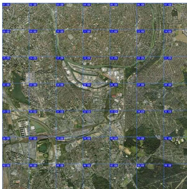
**Figure (29) :** Découpage de l'orthophoto automatique en dalle de 128\*128px
