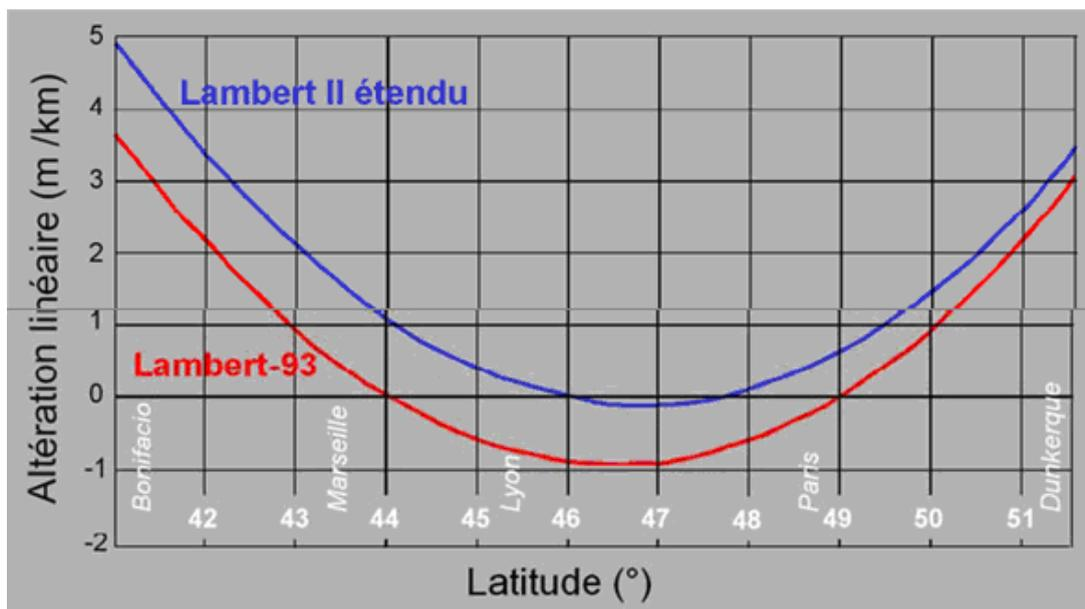
**Figure (9):** Comparaison de l'altération linéaire des projections Lambert II étendu et Lambert 93
