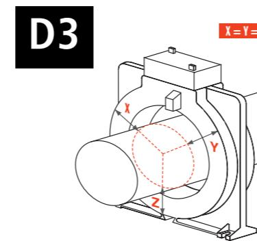
**Diamètre:** diamètre de l'ouverture interne du transformateur (passage câble/barre)
