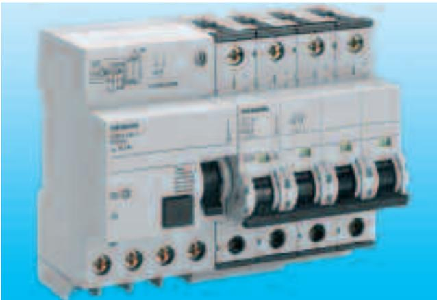
Les deux appareils sont facilement montés ensemble sans outils. Il suffit de serrer les vis de raccordement de la connexion des conducteurs entre le bloc différentiel et le disjoncteur de protection de ligne pour obtenir un ensemble disjoncteur différentiel monobloc.
