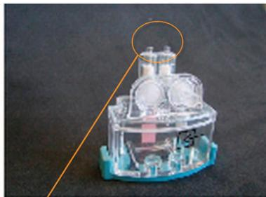
**Correct** : les joints ne restent pas fixés au piège à eau.
