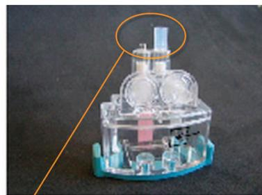
**Incorrect** : l'un ou les deux joints restent fixés au piège à eau.
