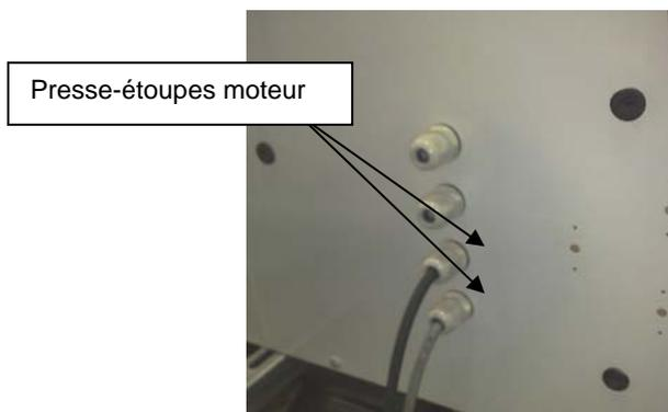
Du fait de l'utilisation d'un variateur de fréquence, il est nécessaire de réaliser le raccordement entre le variateur et les moteurs le plus court possible et avec du câble blindé afin d'éviter les perturbations électromagnétiques. Vérifier l'absence de perturbations. Les moteurs électriques sont équipés de protections thermiques type PTO qui devront être raccordées au système de commande pour assurer la protection contre les surchauffes.
