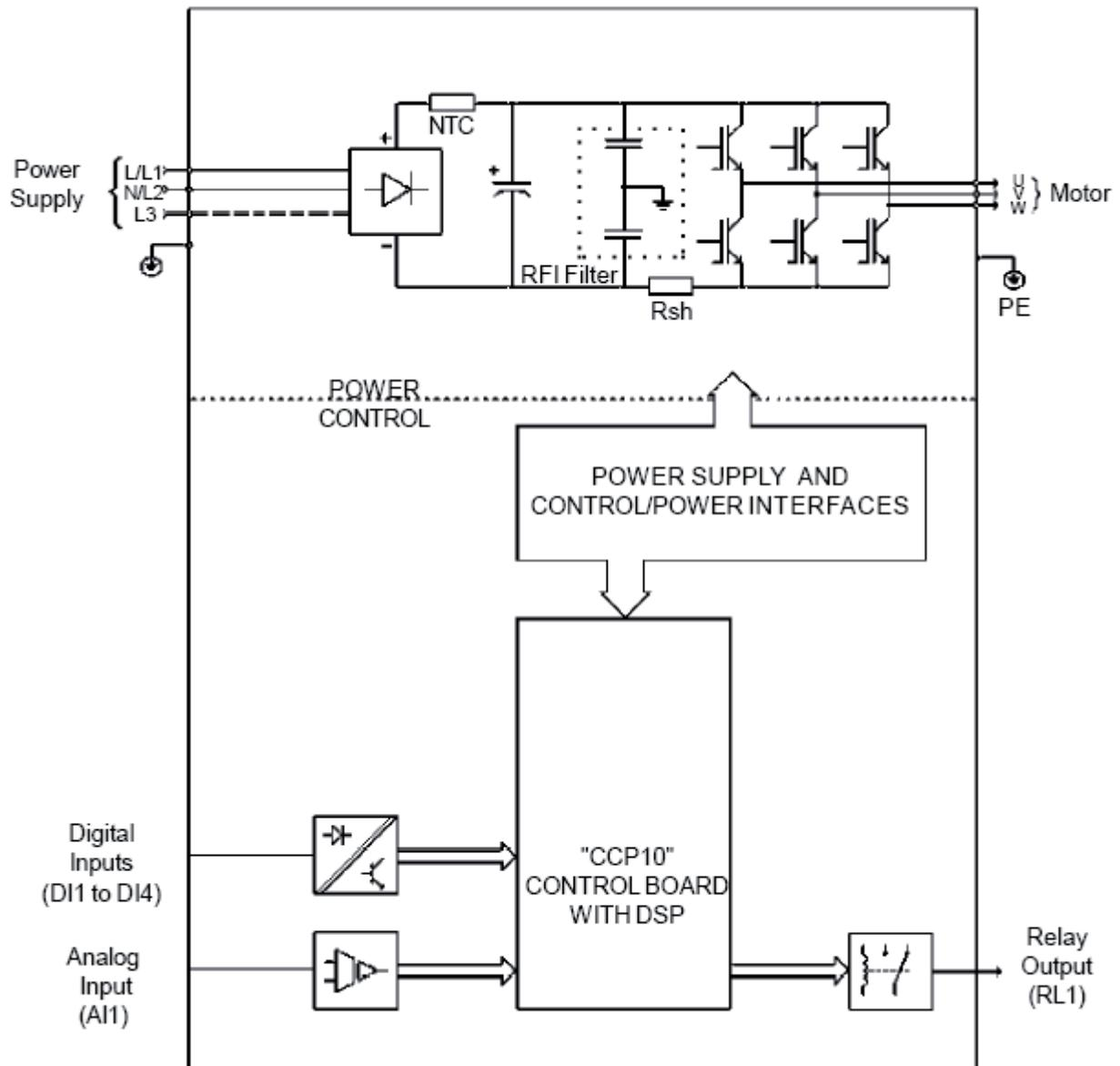
**Figure 2 - CFW-10 Schéma pour les modèles 1,6 A, 2,6 A et 4,0 A / 200-240 V (monophasé) et 1,6 A, 2,6 A, 4,0 A et 7,3 A/200-240 V (triphasé)**
