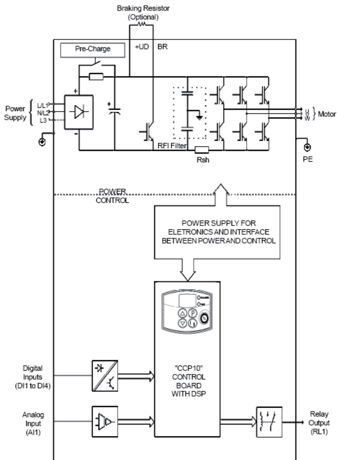
**Figure 3** - CFW-10 Schéma pour le modèle 7.3 et 10.0 A/200-240 V (monophasé) et 10,0 A et 15,2 A/200-240 V (triphasé)
