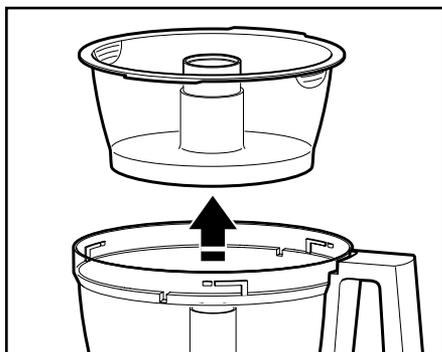
6. Faites pivoter le bol de travail vers la gauche pour le déverrouiller de la base. Ôtez-le en le soulevant.
