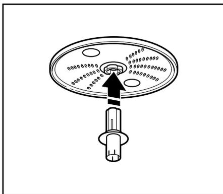
2. Faites glisser l'entraîneur dans l'adaptateur du disque aussi loin que possible, jusqu'à ce qu'il s'enclenche.
