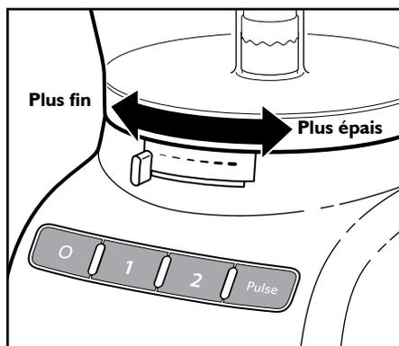
**REMARQUE :** le levier fonctionne uniquement avec le disque à trancher réglable. Si vous l'utilisez pour régler l'épaisseur alors que d'autres disques ou lames sont installées, la modification n'aura aucun effet.
