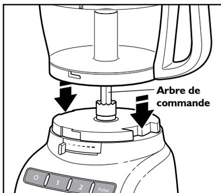
3. Maintenez fermement la poignée du bol de travail et tournez ce dernier dans le sens contraire des aiguilles d'une montre pour le verrouiller sur la base.
