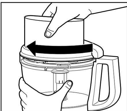
4. Si un disque est installé, ôtez-le avant de retirer le bol. En maintenant le disque à l'aide des deux points de prise, soulevez-le verticalement. Retirez l'adaptateur.
