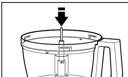
2. Maintenez le disque à trancher réglable à l'aide des deux points de prise et alignez les ergots de l'adaptateur du disque à trancher réglable dans les encoches en L du disque. Faites glisser le disque vers le bas sur l'adaptateur et tournez pour emboîter les ergots dans les encoches en L.
