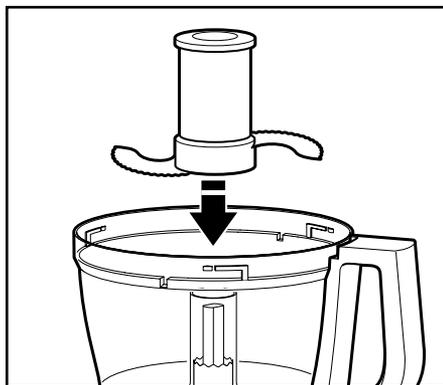
3. Poussez pour verrouiller : enfoncez fermement la lame polyvalente jusqu'au fond, le plus loin possible. Un joint interne lui permet de s'enclencher solidement au centre du bol de travail.
