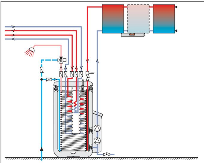
Figure 3-3 Connexion en parallèle d'un groupe de capteurs solaires Solaris et d'un accumulateur Sanicube Solaris
