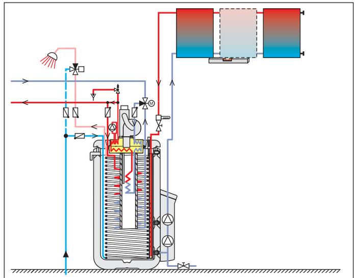
Figure 3-4 Connexion en parallèle d'un groupe de capteurs solaires Solaris et d'une unité GasSolarUnit
