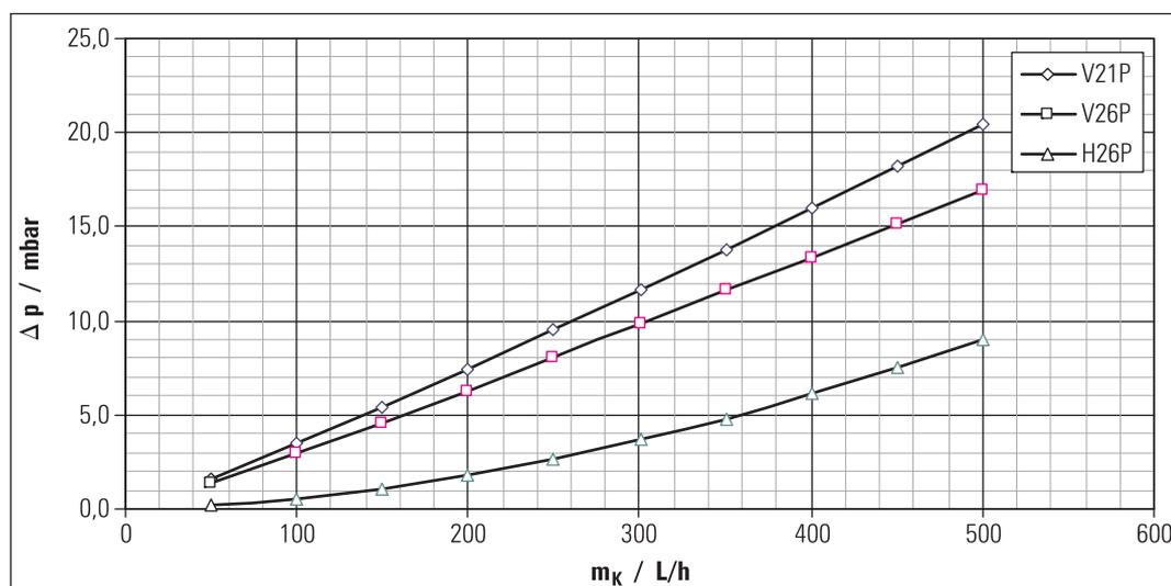
Figure 5-1 Résistance hydraulique capteurs plats
