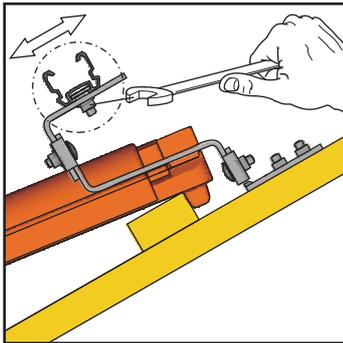
Figure 3-10 Vissez les profilés sur la partie supérieure du crochet de montage sur toit
