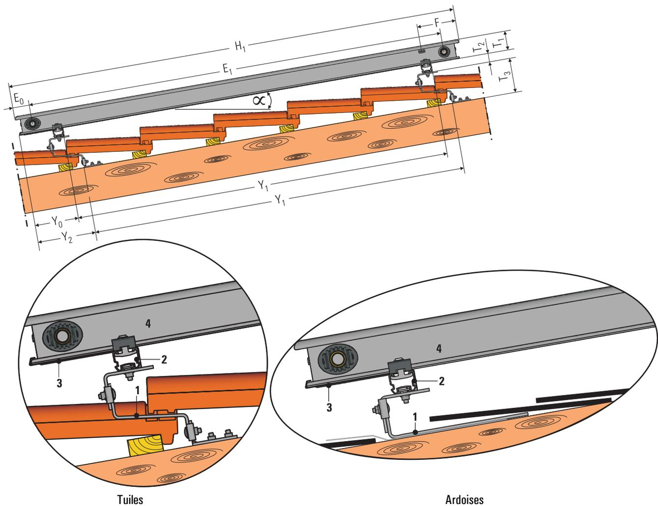
Figure 3-6 Vue latérale d'un capteur solaire Solaris monté sur toiture
