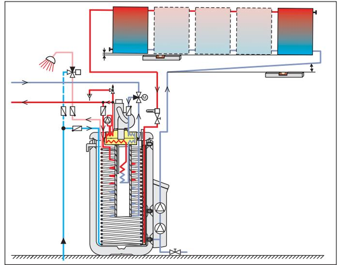
Figure 3-2 Connexion en série d'un groupe de capteurs solaires Solaris et d'une unité GasSolarUnit
