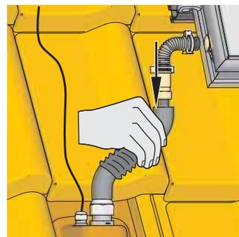
Figure 3-39 Posez les raccords à collerette des coudes du capteur solaire
