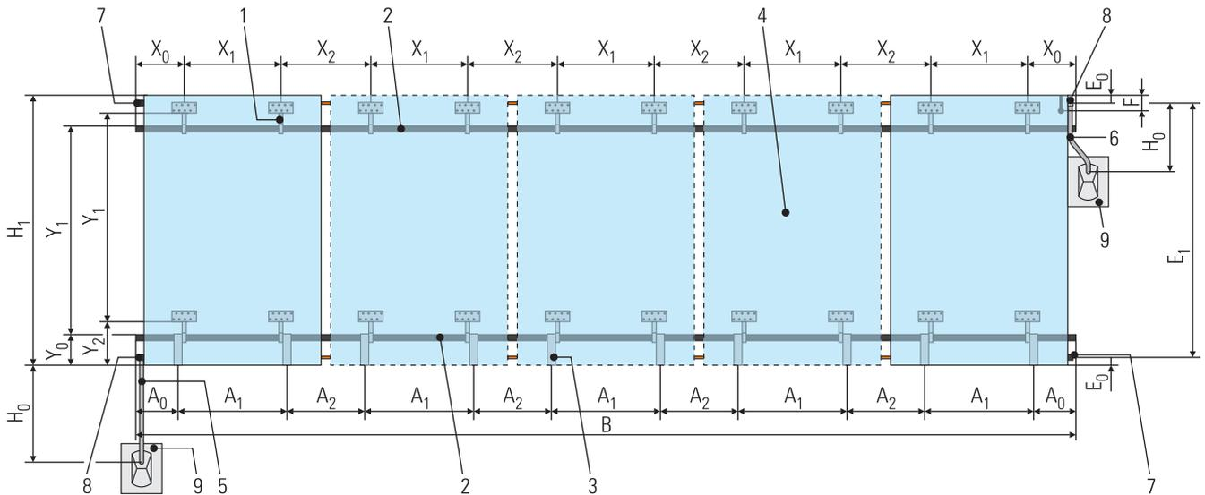
Figure 3-5 Dimensions principales d'un groupe de capteurs solaires Solaris pour montage sur toiture (exemple du capteur solaire V26P)
