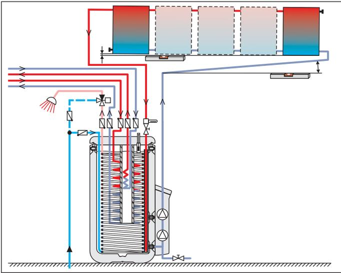
Figure 3-1 Connexion en série d'un groupe de capteurs solaires Solaris et d'un accumulateur Sanicube Solaris
