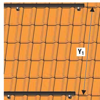
Figure 3-16 Montez les rails de profilé supérieurs (pour les dimensions, voir Tab. 3-2)
