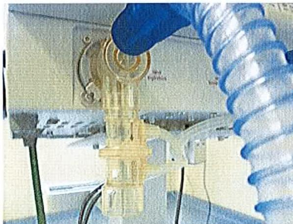
4. Monter un poumon d'essai sur la pièce en Y avec un filtre HME et raccord Mount
