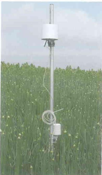
Une station météorologique à transmission GPRS, intégrant un capteur d'humidité relative et de température abrité (en bas sur la station) et un pluviomètre (en haut de la station).
