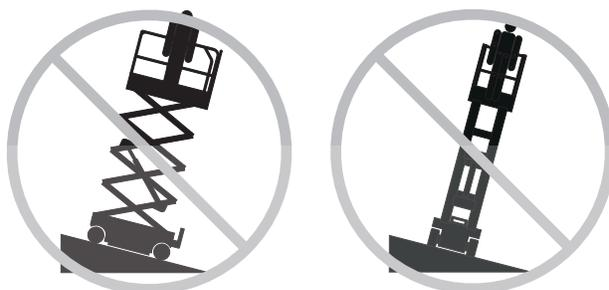
Ne pas se baser sur l'alarme de dévers pour indiquer le niveau. L'alarme de dévers retentit sur le châssis uniquement lorsque la machine se trouve sur une pente.
