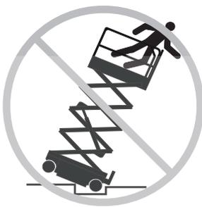
Ne pas conduire la machine avec la nacelle levée sur un terrain accidenté, un revêtement instable ou dans d'autres situations à risque.
