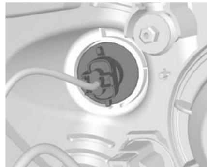
1. Faire tourner la douille de l'ampoule dans le sens antihoraire et la désencliqueter.
