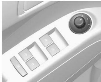
Sélectionner le rétroviseur souhaité en tournant la commande à gauche (**L**) ou à droite (**R**). Puis pivoter le bouton de commande pour régler le rétroviseur.
