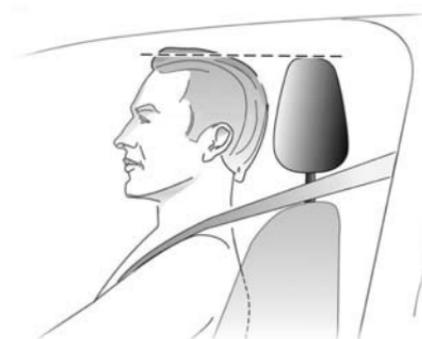
Le bord supérieur de l'appui-tête doit toujours être au niveau du haut de la tête. Si cela s'avérait impossible pour des personnes de très grande taille, l'appui-tête doit être réglé sur la position la plus haute. Pour des personnes de très petite taille, régler l'appui-tête sur la position la plus basse.
