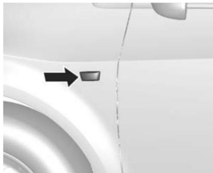
1. Extraire la lampe en faisant levier avec un tournevis. Pousser la lampe vers l'avant (côté conducteur) ou l'arrière (côté passager). Ensuite, faire pivoter la lampe vers le bas et la retirer de l'ouverture.
