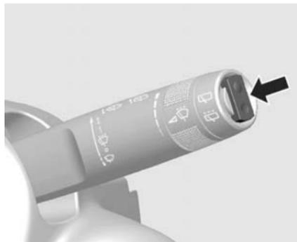
Pour faire fonctionner l'essuie-glace arrière, appuyer sur le commutateur à l'extrémité du levier.
