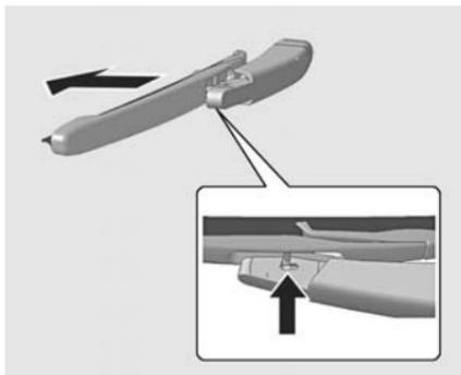
3. Retirer le balais d'essuie-glace de son dispositif de maintien en suivant le trou de guidage.
