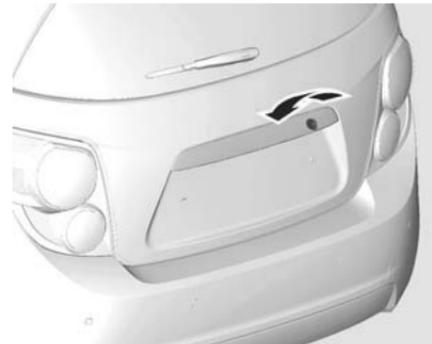
Pour déverrouiller le hayon, insérer la clé dans la serrure et la tourner dans le sens inverse des aiguilles d'une montre. Lever le hayon.
