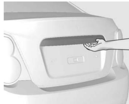
Pour ouvrir le coffre, appuyer sur le bloc tactile quand son couvercle est déverrouillé.
