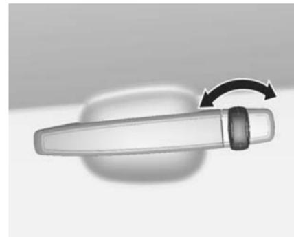
Pour exécuter le verrouillage central manuel des portes, tourner la clé dans sa fente.
