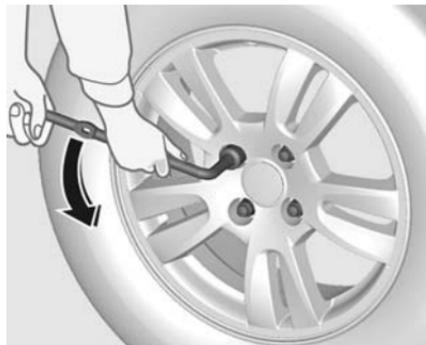
2. Déplier la clé de roue et la placer de sorte qu'elle soit bien positionnée et dévisser chaque écrou de roue d'un demi-tour.
