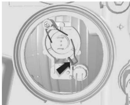
2. Appuyer sur l'attache ressort, la désencliqueter.
