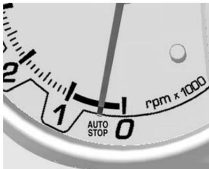
L'arrêt du moteur est indiqué par l'aiguille sur la position **AUTOSTOP** dans le compte-tours.
