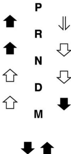
Appuyer sur le bouton de déverrouillage pour changer de gamme. Les flèches indiquent les passages qui ne nécessitent pas de pression sur le bouton de déverrouillage.
