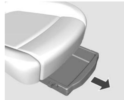
Pour utiliser le bac de rangement sous le siège du passager avant, soulever l'extrémité du bac et la tirer vers le tableau de bord. Pousser le bac vers le siège pour le ramener dans sa position de départ.
