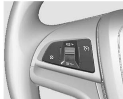
Le limiteur de vitesse permet de définir la vitesse de pointe du véhicule. Si la vitesse maximale enregistrée est dépassée, le système en informe le conducteur par un voyant ou un signal sonore.
