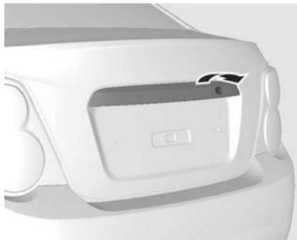
Pour déverrouiller le coffre, introduire la clé dans la serrure et la tourner dans le sens des aiguilles d'une montre. Lever le couvercle de coffre.
