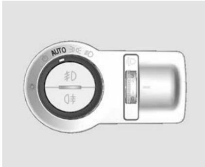
Quand la luminosité extérieure est faible, les feux et l'éclairage du tableau de bord s'allument automatiquement si la commande d'éclairage automatique est activée.
