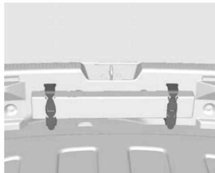
Le triangle de présignalisation peut se ranger dans la garniture arrière avec les deux sangles en caoutchouc.
