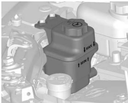
Le niveau de liquide de direction assistée doit se situer entre **MIN** et **MAX**.
