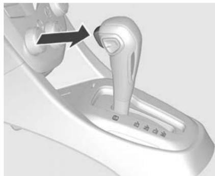
**P (stationnement)** : Bloque les roues avant. Sélectionner P uniquement quand le véhicule est à l'arrêt et que le frein de stationnement est serré.
