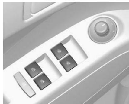
Les lève-vitres électriques fonctionnent quand le contact est mis.
