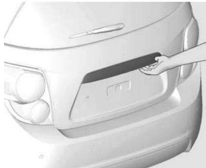
Pour ouvrir le hayon, appuyer sur le bloc tactile une fois le hayon déverrouillé.
