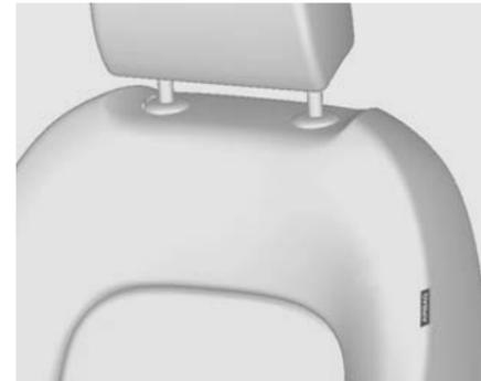
Le système d'airbags latéraux se compose d'un airbag dans chacun des dossiers de siège avant.
