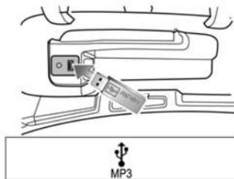
Tirer sur le couvercle situé au-dessus du tableau de bord pour l'ouvrir et brancher au port USB le périphérique de stockage USB où se trouvent les fichiers à lire.
