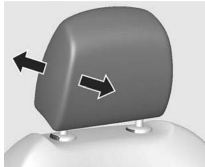
Tirer l'appui-tête vers l'avant. Il est réglé à trois positions. Pour le déplacer vers l'arrière, tirer l'appui-tête vers l'avant. Il revient ensuite automatiquement vers l'arrière.
