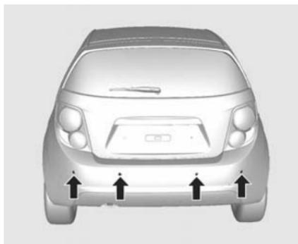
L'aide au stationnement facilite les manœuvres de stationnement en mesurant la distance entre le véhicule et les obstacles à l'arrière et en émettant un signal sonore dans l'habitacle. C'est toutefois le conducteur qui reste pleinement responsable du station-
