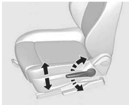
Pomper avec le levier placé à l'extérieur de l'assise de siège jusqu'à ce que celle-ci se trouve à la position désirée.
