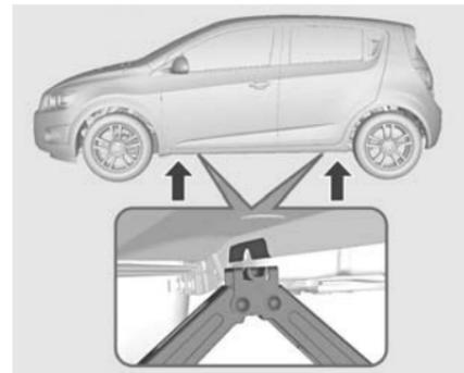
3. Faire tourner la manivelle pour soulever légèrement la tête de levage et placer le cric verticalement à l'endroit repéré par un demi-cercle.
