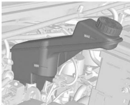
Le niveau de liquide de frein doit se situer entre **MIN** et **MAX**.
