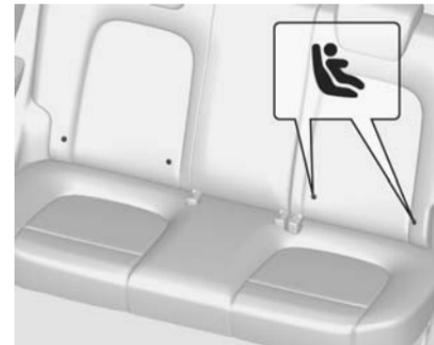
2. Repérer les deux positions d'ancrage inférieures. L'emplacement de chaque ancrage inférieur est identifié au moyen d'une marque circulaire sur le bord inférieur du dossier de siège arrière.
