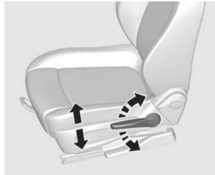
Pomper le levier à l'extérieur de l'assise de siège jusqu'à ce que celle-ci se trouve à la position désirée.
