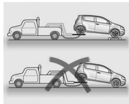
Lors d'un remorquage par 2 roues, soulever les roues motrices avant et remorquer avec les roues avant verrouillées.
