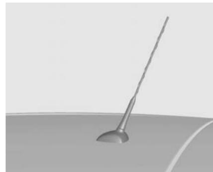
Pour déposer l'antenne de toit, la faire tourner dans le sens inverse des aiguilles d'une montre. Pour poser l'antenne de toit, la faire tourner dans le sens des aiguilles d'une montre.
