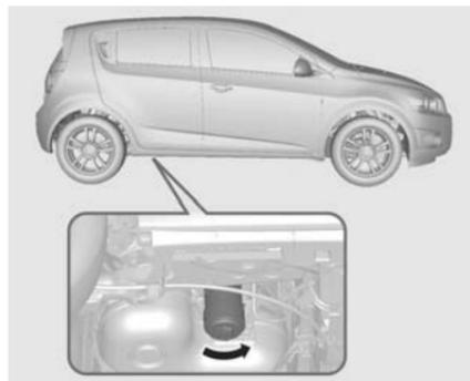
1. Confirmer le filtre à carburant autour du réservoir à carburant.
