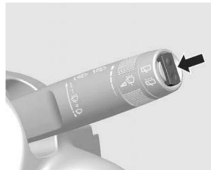
Appuyer sur la partie supérieure du commutateur pour que les essuie-glace fonctionnent en continu.
