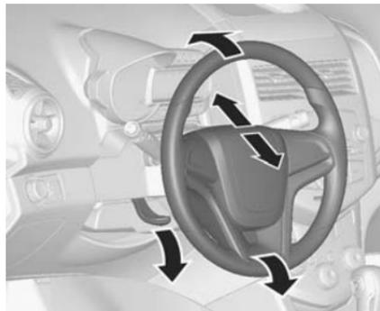
Débloquer le levier, régler le volant puis bloquer le levier et vérifier qu'il est bien verrouillé. Ne régler le volant que si le véhicule est à l'arrêt.
