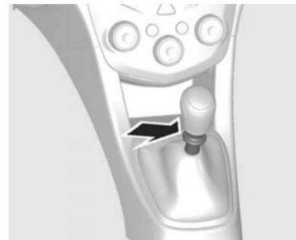
Pour engager la marche arrière, soulever la bague se trouvant sur le levier avec le véhicule à l'arrêt et engager le rapport.
