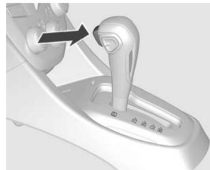
Le déplacement entre certaines positions nécessite d'enfoncer le bouton de déverrouillage situé sur le côté du levier sélecteur.
