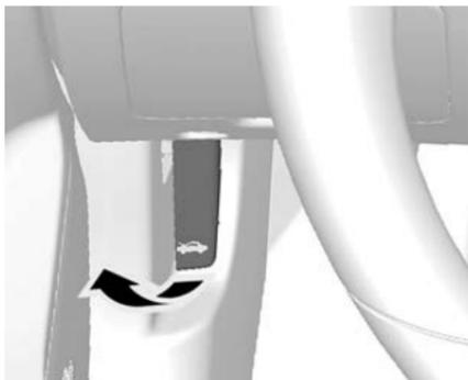
1. Tirer le levier de déverrouillage et le ramener dans sa position de départ.
