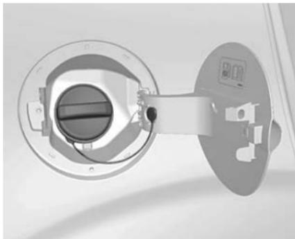
5. Si le bouchon est verrouillé, le déverrouiller avec la clé de contact. Enlever le bouchon. Le bouchon est attaché au crochet de la charnière.
