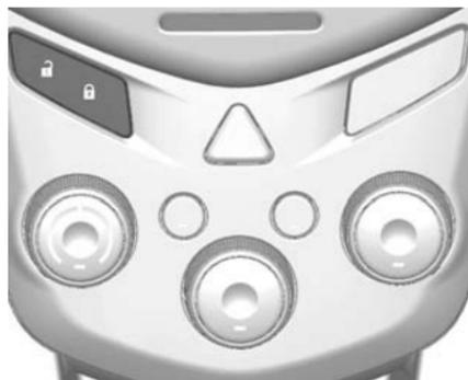
Verrouille ou déverrouille toutes les portes, le hayon (ou le coffre) et la trappe de remplissage du carburant.
