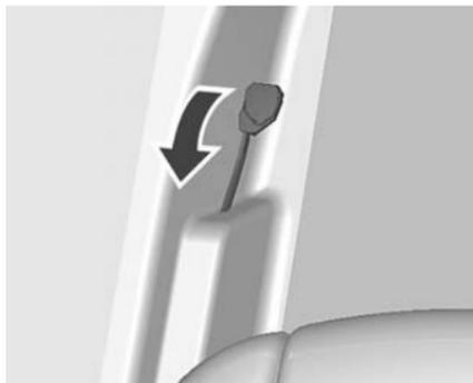
On peut aussi ouvrir le coffre en tirant sur le levier situé près du siège du conducteur.
