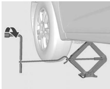
5. Tourner la clé en vérifiant le positionnement correct du cric jusqu'à ce que la roue ait quitté le sol.
