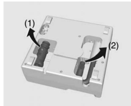
3. Enlever le câble de raccordement électrique (1) et le flexible d'air (2) de leur espace de rangement sur la face inférieure du compresseur.
