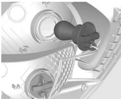
5. Enlever le support d'ampoule. Pousser légèrement l'ampoule dans la douille, la tourner dans le sens antihoraire, l'enlever et remplacer l'ampoule.
