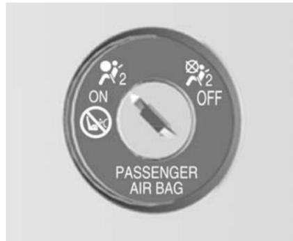
Le système d'airbags de passager avant peut être désactivé à l'aide d'une serrure située sur le côté du tableau de bord, visible quand la porte passager est ouverte.
