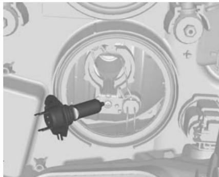
4. Débrancher le connecteur de l'ampoule.
