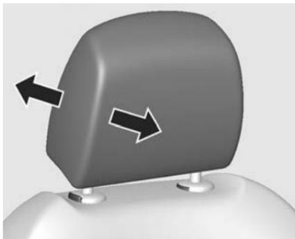
Tirer l'appui-tête vers l'avant. Il est réglé à trois positions. Pour le déplacer vers l'arrière, tirer l'appui-tête vers l'avant. Il revient en arrière automatiquement.
