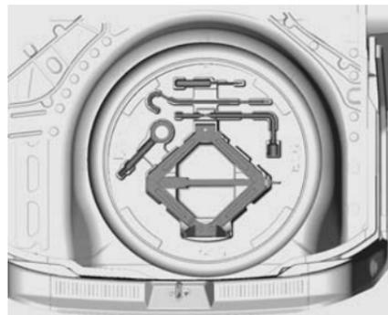
Le cric et les outils se trouvent dans un compartiment de rangement au-dessus de la roue de secours dans le coffre.
