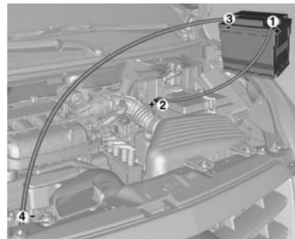
Séquence de raccordement des câbles :
