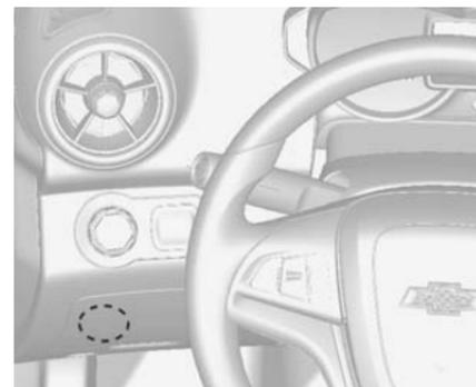
La boîte à fusibles intérieure se trouve sous la face inférieure du tableau de bord, côté conducteur.
