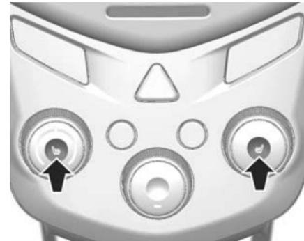
Les touches du chauffage des sièges se trouvent dans les boutons de commande de la régulation de température.
