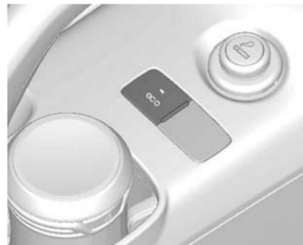
Pour désactiver le système Stop/Start manuellement, appuyer sur le bouton **eco**.
