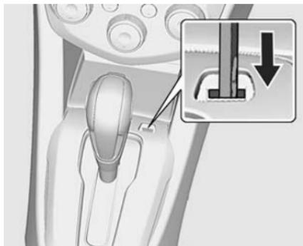
4. Insérer et enfoncer la clé de contact dans la fente.
