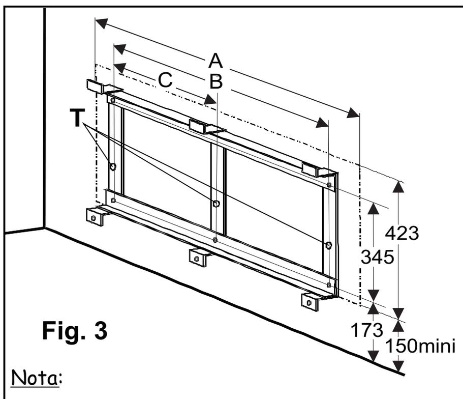
Pour effectuer cette opération, ôter les vis de fixation du dossier en bas de l'appareil (elles serviront pour la fixation au mur) à l'aide d'un tournevis. Poser le dossier sur la paroi à l'aide de 4 ou 6 vis ( $\varnothing 5.5\text{mm Max.}$ ) en s'assurant de l'orienter dans le bon sens et à la bonne hauteur (voir Fig. 3).
