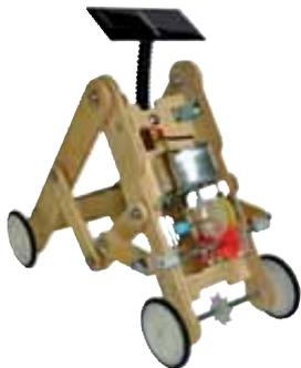
Ludique et facile à assembler, ce kit est une excellente introduction à l'énergie solaire. Une fois monté, le mobile en bois se déplace par mouvement en accordéon grâce à son panneau solaire.
