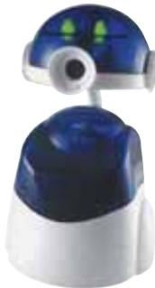
Ce kit permet de construire un sympathique robot détecteur de bruits. Ses 4 microphones intégrés détectent le son et font tourner le robot. L'assemblage est très simple et ne nécessite pas de soudure.
