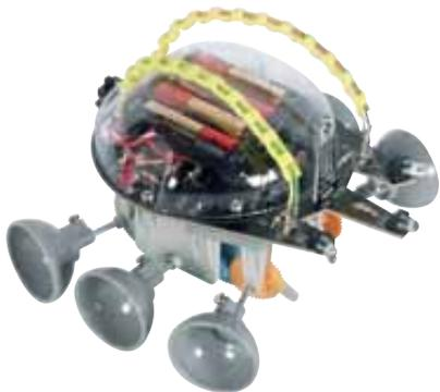
Ce kit permet d'assembler un robot qui fonctionne comme un robot à intelligence artificielle et s'échappe des labyrinthes les plus compliqués par un système de détection IR.
