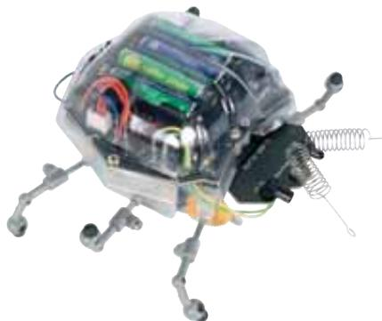
Ce kit permet d'assembler un robot qui se déplace grâce à ses six pattes, et utilise ses yeux, à l'aide d'infrarouges, pour esquiver les obstacles qu'il rencontre sur son chemin. Ce kit utilise deux type de pattes, des diodes infrarouges et deux groupes de moteurs avec engrenages.
