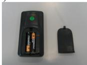
2. Ouvrez le couvercle sur le dessous du mur virtuel, en tournant le bouton de telle façon que la partie droite s'aligne avec l'ouverture du couvercle. Placez deux piles type D dans le compartiment (pas inclus). Refermez le couvercle.
