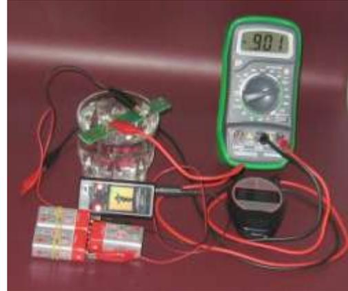
Si vous avez un voltmètre branché à la sortie (1<sup>er</sup> niveau=9uS), surveillez entre 16.5V et 15.5V
