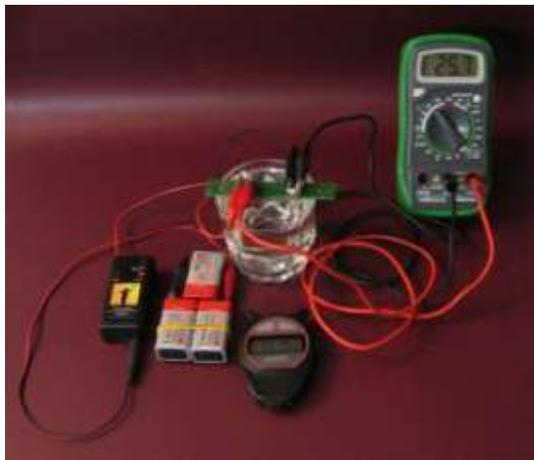
Si vous mesurez le voltage aux bornes de la sortie, vous trouverez un voltage proche de 24V avec 3 batteries de 9V. Ici, 25.7V
