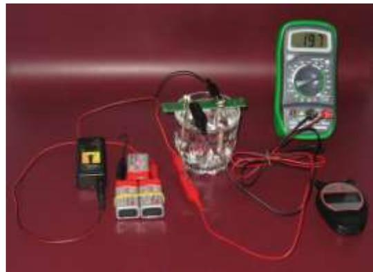
Avec des instruments de mesure, vous pourriez mesurer un très faible courant de sortie de 100 à 200  $\mu\text{A}$  : L'eau distillée est presque isolante, et le courant a beaucoup de difficulté à passer. Si vous utilisez de l'eau bi-distillée ou (encore pire) tri-distillée, le courant sera encore plus faible. Ici, 197 $\mu\text{A}$ , ou 0.197mA
