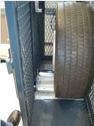
Le système de sortie avec rouleaux bascule le rouleau arrière, de sorte que la roue puisse sortir facilement.
