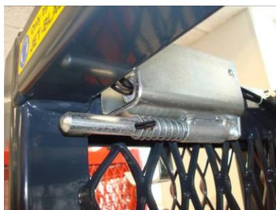
**Duplex:** 2 couches de métal déployé de sécurité, qui invertissent l'onde de choc et protègent contre les fragments en cas d'explosion du pneu.
