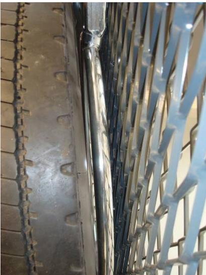
Lorsque l'on utilise le Système Oméga Jet, il faut régler la hauteur du Jet ring (l'anneau) par rapport à la jante.
