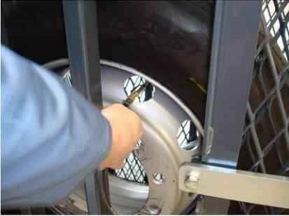
Monter le raccord / la connexion sur la valve.
