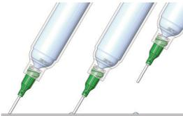
**Attention** - l'aiguille doit toujours être mise en contact avec la surface de travail selon l'angle indiqué. Une fois l'aiguille en position, appuyez sur la pédale de commande. Relâchez la pédale et remontez l'aiguille en la soulevant à la verticale.
