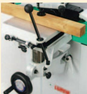
La mortaiseuse type B à montée indépendante.
