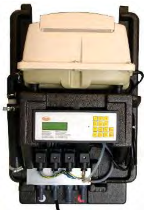
Vue de côté de l'armoire de pilotage interne. Code couleurs pour le branchement des tuyaux d'air sur les raccords.
