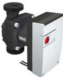
La pompe à haut rendement est une pompe à rotor noyé dotée de la technologie "Electric Commutator Motor" (ECM) intégrant un variateur électronique qui permet d'adapter automatiquement la puissance de la pompe en fonction de la charge variable de l'installation.
