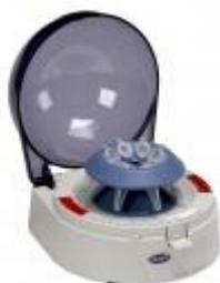
*Mini-centrifugeuse à vitesse fixe - 6000 tours / min.
