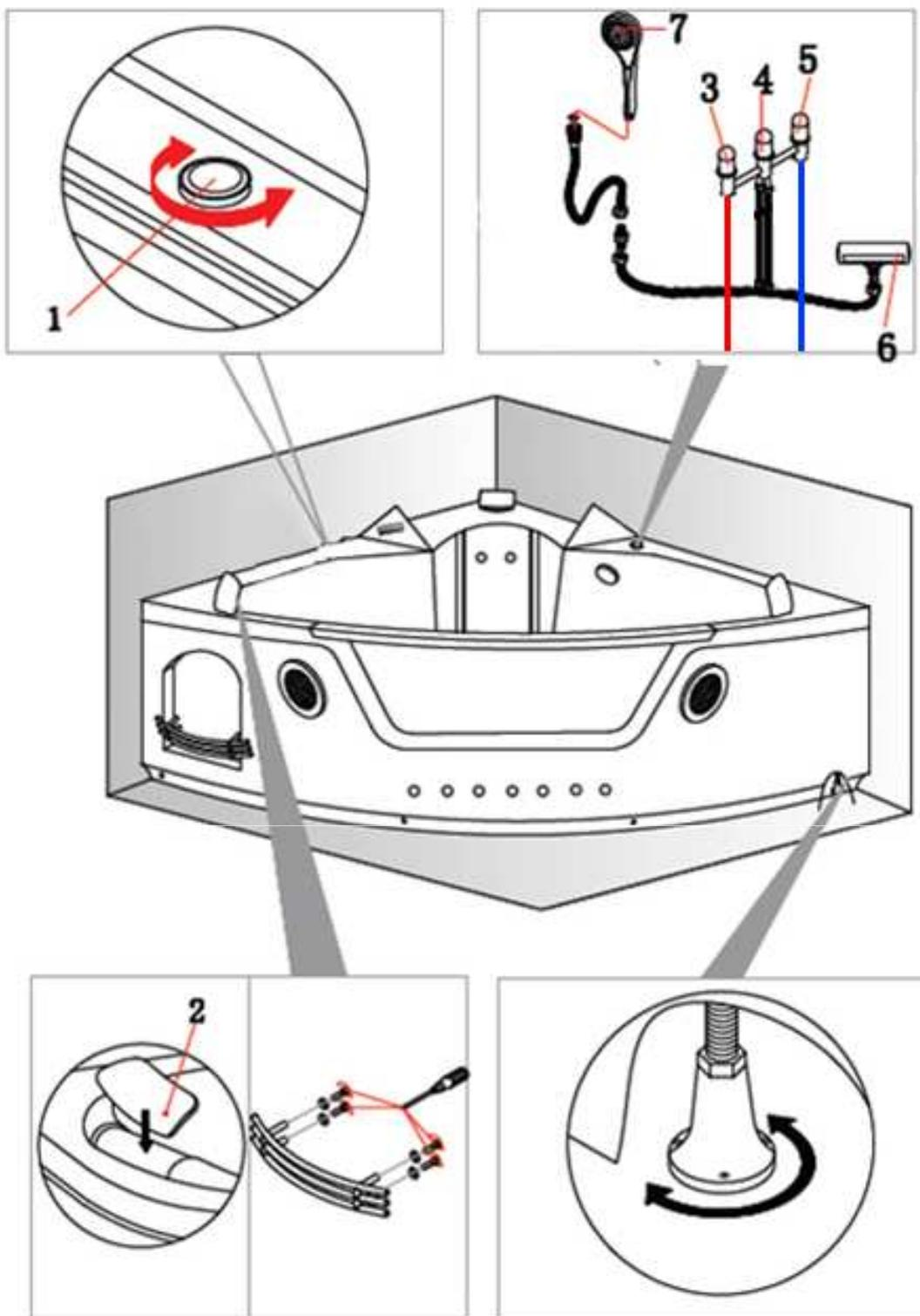
Installer les raccords des différentes parties suivant le schéma ci-dessus.
