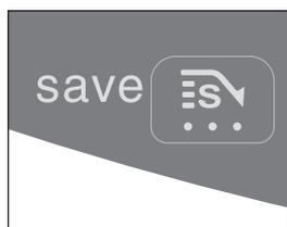
I: Si la lampe témoin SAVE s'allume, l'appareil s'allume et s'éteint automatiquement afin de rester dans les limites d'une certaine plage de températures.
