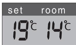
F: A gauche la température désirée, à droite la température mesurée.
