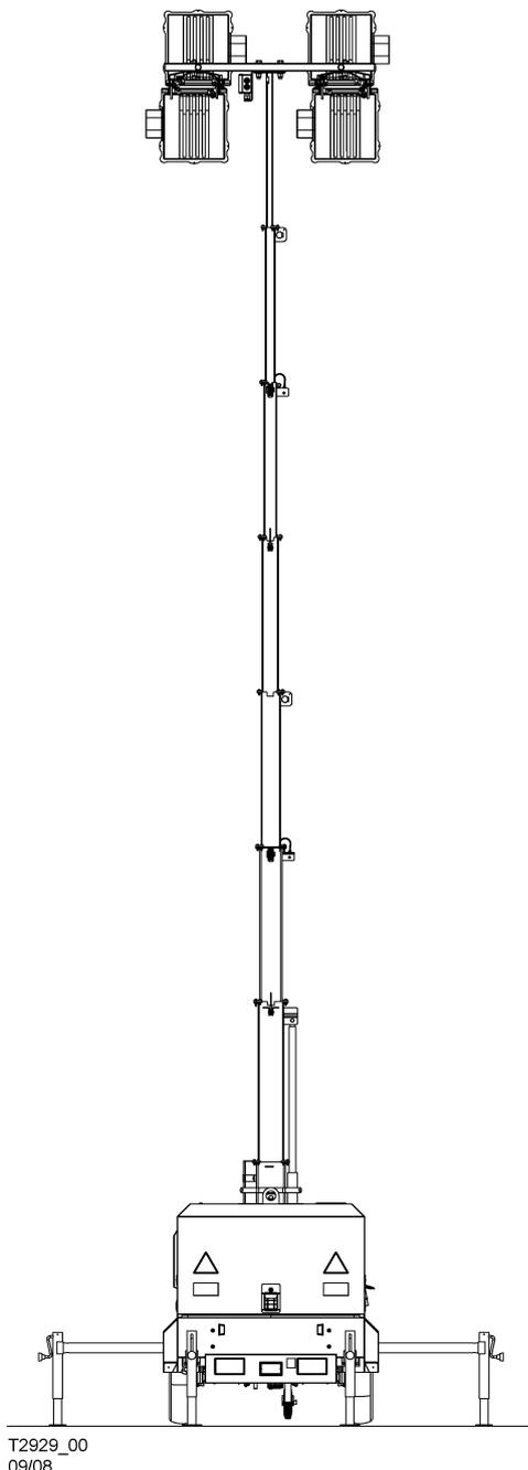
NE PAS monter sur la tour. Effectuer les réparations et les réglages lorsque la tour est abaissée (position de transport).
