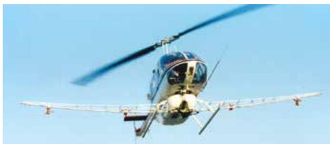
longueurs, adaptées à la plage de vitesse de l'appareil utilisé. Pour des vitesses inférieures à 145 km/h (90 miles/h), il est recommandé d'utiliser les atomiseurs AU7000.
