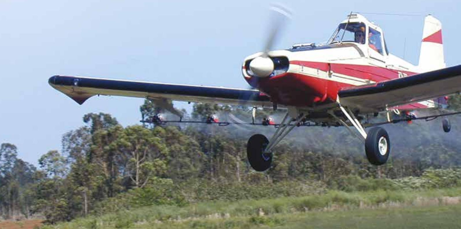
L'atomiseur AU5000 est le fruit de plus de cinquante années d'expérience dans la conception et l'utilisation d'atomiseurs rotatifs pour l'aviation agricole. Aujourd'hui, les atomiseurs Micronair sont utilisés dans plus de 90 pays et installés sur plus de trente types d'avions et hélicoptères. Ce savoir-faire unique, combiné à un programme de recherche et développement continu, a donné naissance à un atomiseur polyvalent et fiable, adapté aux besoins de la pulvérisation agricole aérienne.
