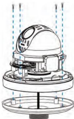
8. Remettre le couvercle en forme de dôme en s'assurant que le joint torique en caoutchouc autour de la base de la caméra est en place et que la flèche d'alignement\* du couvercle en dôme est vis-à-vis la base de la caméra.
