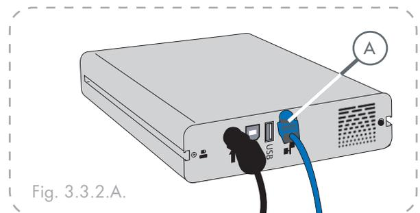
1. Branchez le câble Ethernet au port Ethernet situé à l'arrière du disque LaCie Ethernet Disk mini (A).
