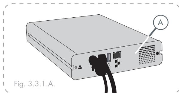
1. Branchez le câble USB au port USB situé à l'arrière du disque LaCie Ethernet Disk mini (A).
