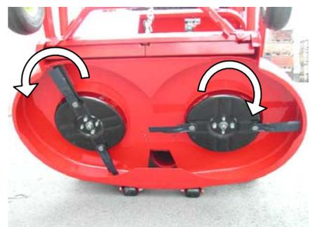
Avant toute intervention sur le plateau de coupe pour opérations de nettoyage, réparation, entretien, réglage, etc., débrayez la prise de force, arrêtez le moteur et retirez la clé de démarrage.
