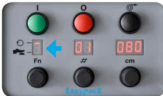
1. Tourner le potentiomètre jusqu'à l'indicateur du symbole « cycle automatique ».
