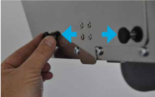
1. Dévissez les deux boutons noirs fixé sur la porte d'accès sous la trappe de sortie du papier.
