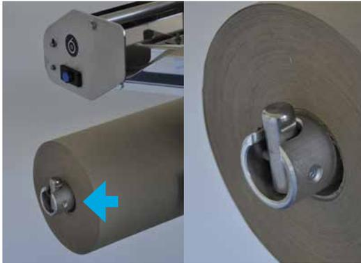
1. En suivant le sens de déroulement, faire glisser un nouveau rouleau de papier sur le bras de chargement jusqu'au loquet à ressort.
