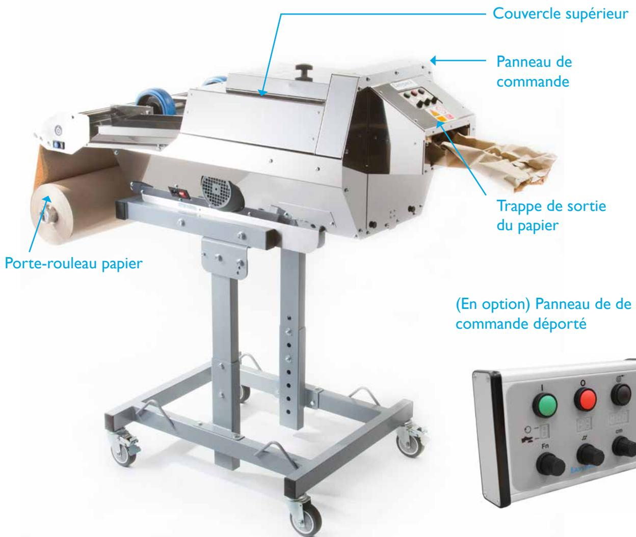
La machine est conçue pour répondre aux normes de sécurité CE en vigueur et nécessite une connexion unique à une alimentation électrique adaptée. Les niveaux de bruit n'excède pas 70 dB (A).
