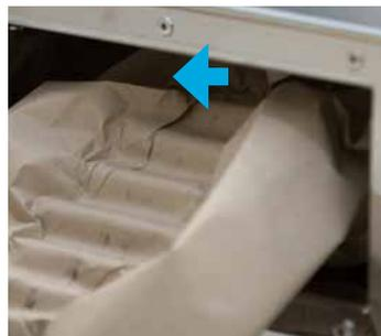
4. La machine ne s'allume pas et ne démarre si le volet de sortie est ouvert.
