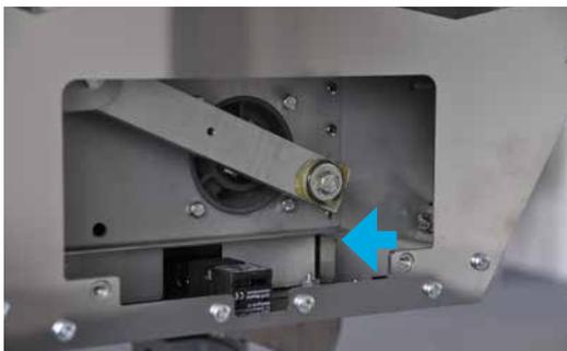
3. Retirez tout papier hors du mécanisme de la lame.
