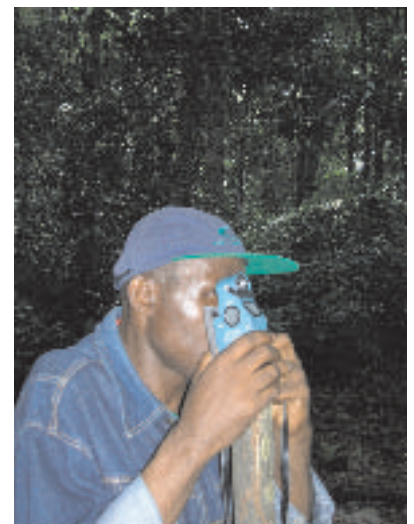
Visée au relascope de Bitterlich © Benoît DEMARQUEZ
