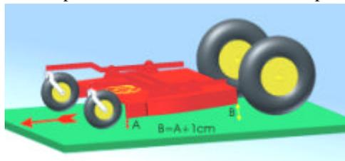
A fin de réglage vérifier que le côté arrière de la tondeuse est plus haut d'environ 1 centimètre.
