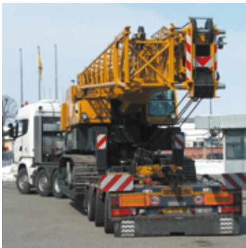
La **SHERPA** è una gru molto compatta e viene trasportata senza dover smontare NIENTE. cingoli e contrappeso restano montati.
