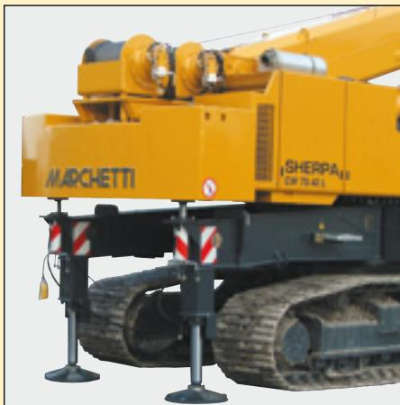
La **SHERPA** è dotata di un unico contrappeso da 9 t che può essere smontato e rimontato dall'operatore con l'aiuto di un apposito sistema opzionale che consiste in due cilindri idraulici opportunamente posizionati sugli stabilizzatori, e collegati con attacchi rapidi all'impianto idraulico, sollevano il blocco zavorra e ne permettono lo sgancio e laggancio alla torre. Il blocco può essere movimentato a piacere dalla stessa gru.
