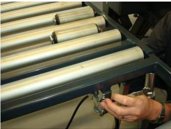
Ajuster la hauteur du système de capteurs
