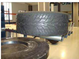
La roue est roulée éventuellement sur un outil de décollage des bourrelets ou un démonte-pneu.
