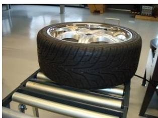
L'inclinaison de 3 - 10°, individuellement réglée, de la table de chargement fait que la roue roule vers la butée en extrémité de table.
