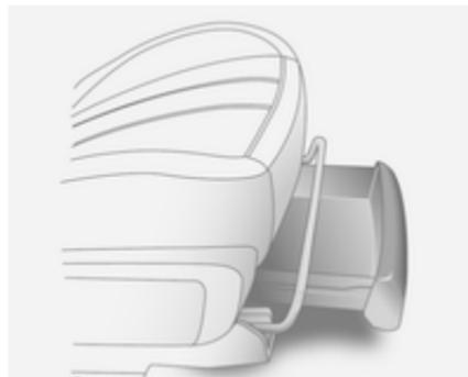
Tirer l'avant du bac vers le haut, puis vers l'avant. Pousser le bac vers le siège pour le remettre à sa position d'origine.
