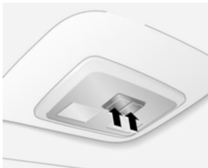
Les lampes de lecture arrière gauche et droite fonctionnent séparément. Appuyer pour les allumer et les éteindre.
