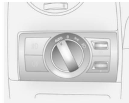
Quand la fonction de commande automatique des feux est activée et que le moteur tourne, les feux de croisement s'allument automatiquement en fonction de la luminosité extérieure.
