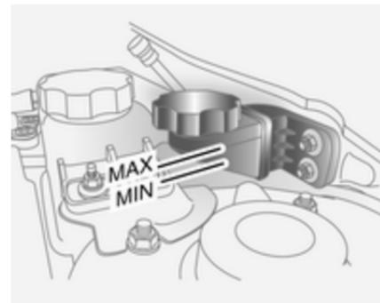
Si le liquide dans le réservoir descend sous le repère **MIN**, prendre contact avec un atelier.
