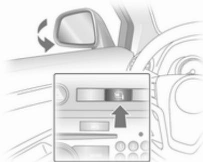
Passer la clé de contact en position **ACC** ou **ON** et appuyer sur le bouton
