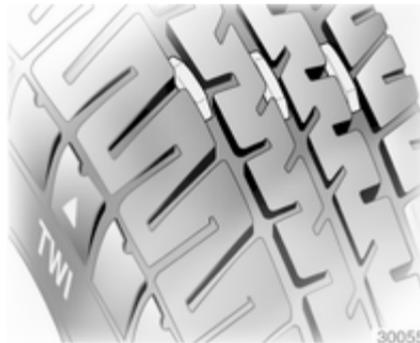
La profondeur minimale de sculpture légalement autorisée (1,6 mm) est atteinte lorsque le profil est usé jusqu'au repère d'usure (TWI). La position des repères d'usure est indiquée par des marques sur les flancs du pneu.
