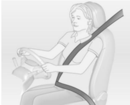
Le blocage des ceintures de sécurité lors d'accélération ou de décélération brutales du véhicule assure le maintien des occupants en position assise. Le risque de blessure est ainsi sensiblement réduit.
