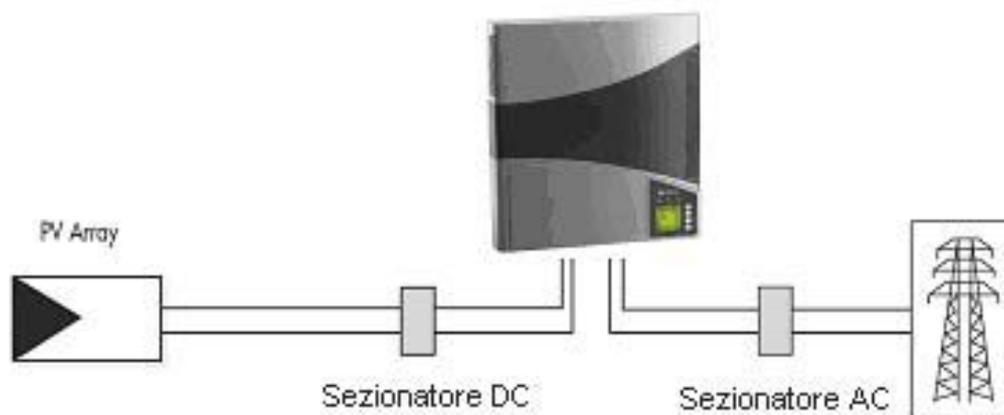
**Fig. 3 - Schéma simplifié d'un système photovoltaïque**
