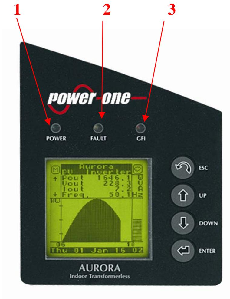
Fig. 13 - Position des LEDs
