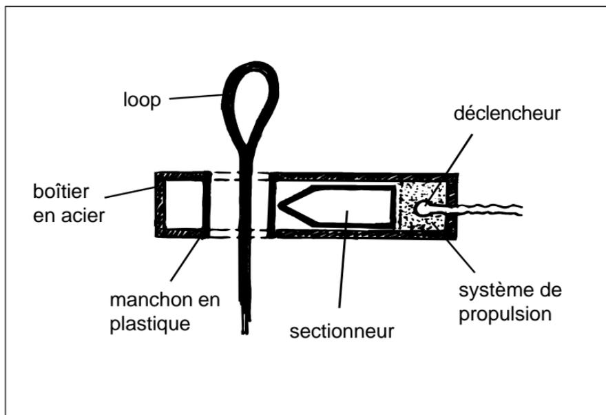
Lors du déclenchement, le sectionneur avance d'environ 5 mm.
