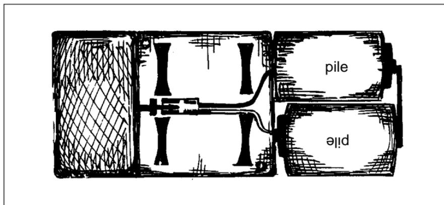
Prenez les piles entre le pouce et l'index et basculez-les au-dessus du boîtier jusqu'à pouvoir les faire descendre verticalement dans ce dernier.
