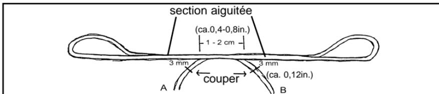
**Important:** Les extrémités libres A et B doivent se superposer au centre de la boucle produite sur 1 à 2 cm (0,4 à 0,8 pouces).
