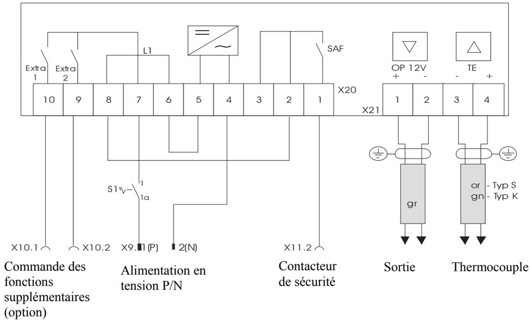
Fig. 28 : Fours > 3,6 kW avec contacteur de chauffage
