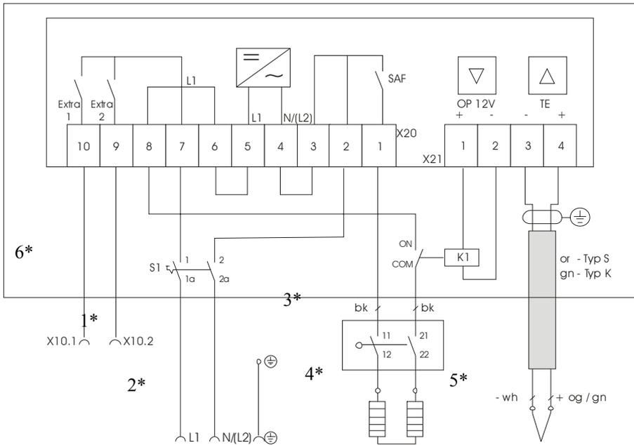
Fig. 30 : Programmeur de recharge pour tous les anciens modèles S jusqu'à 3,6 kW
