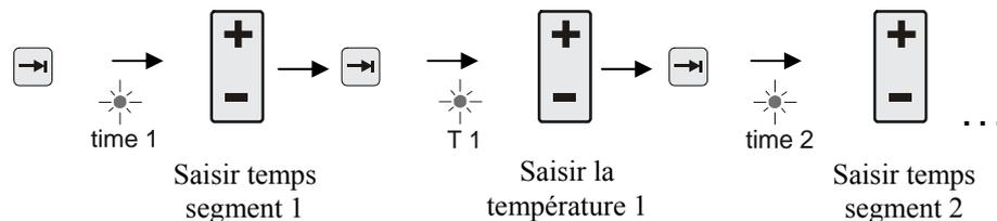
À l'afficheur est indiquée la valeur de température « **T** » ou celle de temps « **time** » correspondant à la diode lumineuse clignotante.
