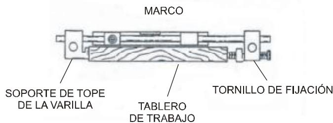
6. Afloje las tuercas de aletas en los soportes de tope de las varillas y deslice ambos soportes hacia arriba contra la parte trasera del tablero de trabajo. (Vuelva a apretar las tuercas de aletas).
