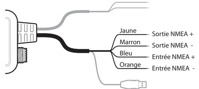
Schéma 8 Se connecter au port de données NMEA0183
