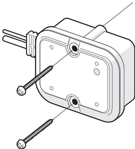
Schéma 6 Fixation de l'AIS RX-100
