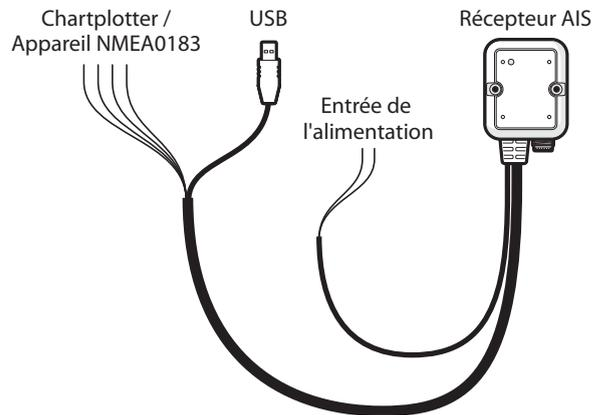
Schéma 3 Branchements électriques à l'AIS RX-100
