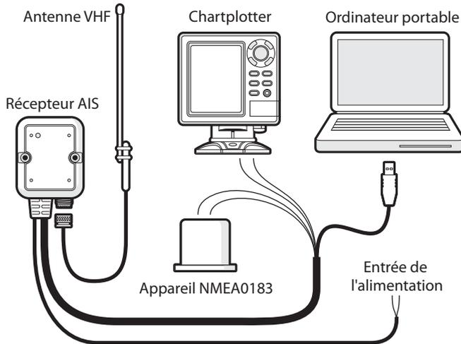
Schéma 4 Configuration d'installation typique
