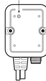
Schéma 10 Emplacement de l'indicateur sur l'unité AIS RX-100
