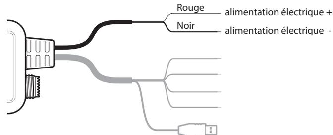
Schéma 9 Brancher l'alimentation électrique
