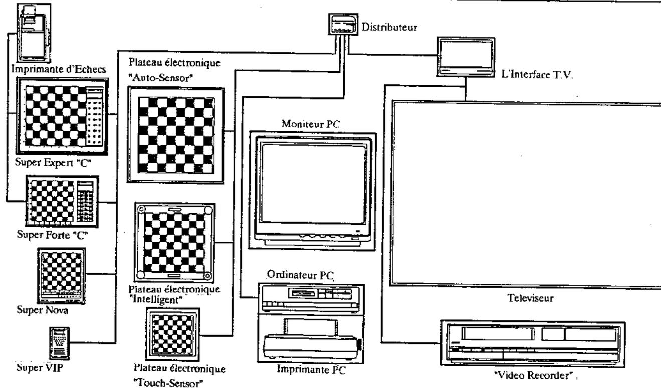
D. Reliez le câble d'alimentation (uniquement pour les modèles Super VIP et Super NOVA) entre votre ordinateur d'échecs NOVAG et l'une de deux prise située à l'arrière de votre Super System Interface TV marquée 9 Volts DC.
