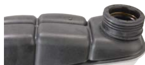
Réservoir de liquide de refroidissement
