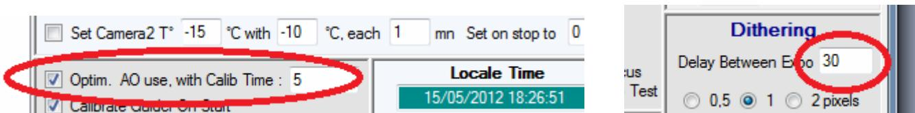
Si vous utilisez une Optique Active AO, entre chaque pose, Maxpilote va ordonner le repositionnement au neutre de la lame de votre AO, le recalage de l'étoile guide par rapport au dithering. Attention de mettre un délai suffisant entre deux poses pour cette opération.
