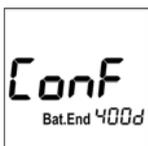
Après finalisation de l'étalonnage, le LIBERO se trouve en mode ConF. Pour afficher/contrôler l'étalonnage.
