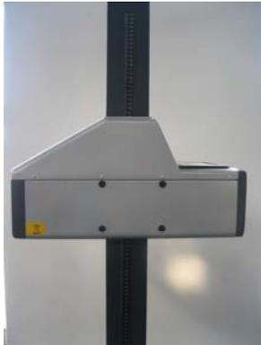
La boîte optique coulisse sur la colonne verticale, on peut donc régler la hauteur très facilement, de plus la colonne est munie d'une échelle graduée en centimètre.
