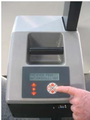
Vérifier l'existence sur le véhicule d'éventuels phares antibrouillard et dans ce cas confirmer par les touches UP et bas DW et appuyer sur la touche OK
