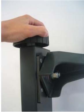
La colonne peut tourner d'environ 30° afin de permettre un alignement optimal avec le véhicule.
