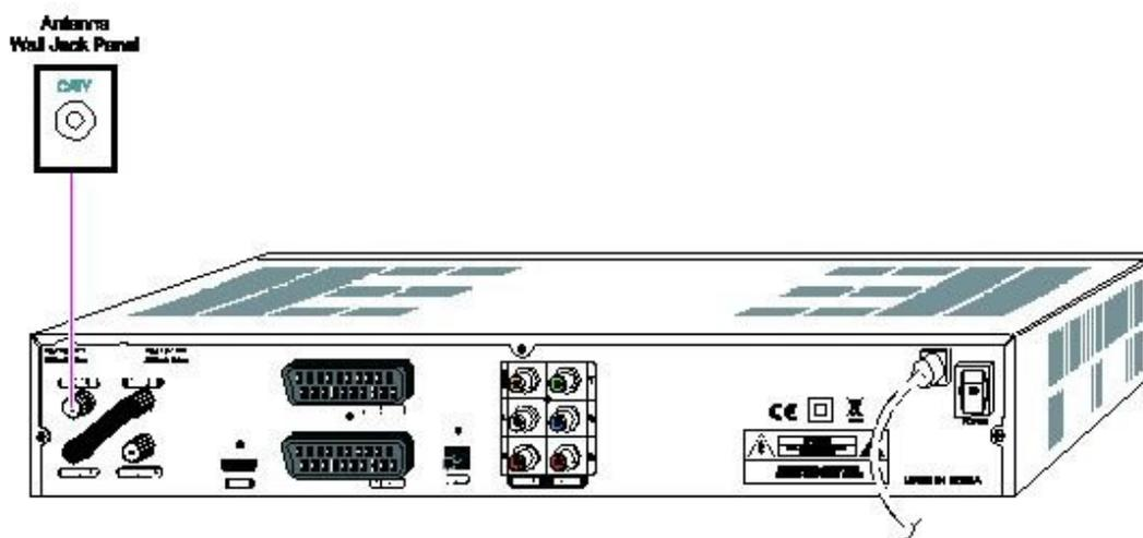
Remarque: Connectez le câble RF entre tuner 1 et tuner 2 .
