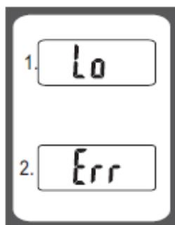
1. Lo = pile faible. Remplacer la pile.
